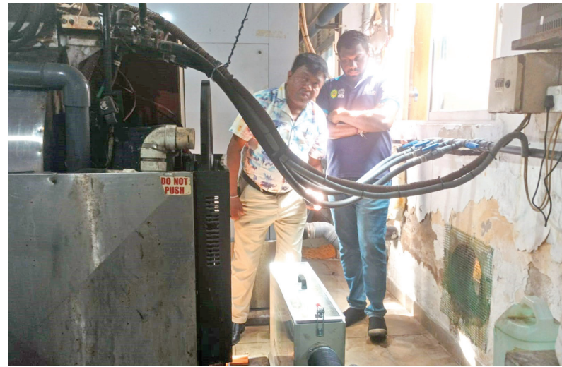
රෙදි සෝදන යන්ත්‍රයේ අපිරිසිදු ජලය පිටවන තලයට පෙරණය සවිකර ඇති අයුරු.
