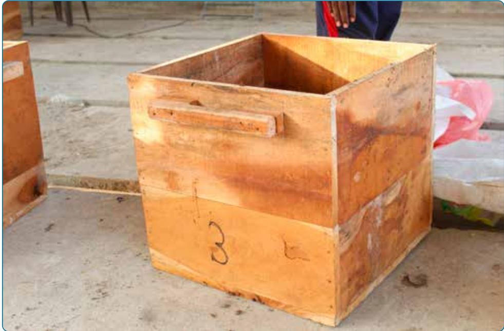
12 රූප සටහන: කසළවල පරිමාව ලබා ගැනීම සඳහා වූ දැවමය පෙට්ටිය
