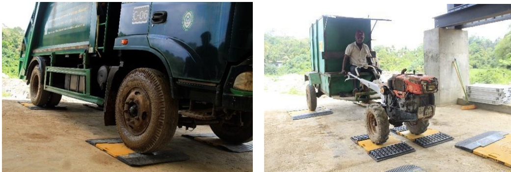
6 රූප සටහන: ගාල්ල මහා නගර සභාව සතු කසළ එකතු කිරීමේ වාහන ඇණයෙහි බර මැනීම (මූලාශ්‍රය: WACS වාර්තාව, 2023)
