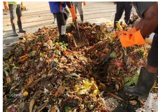
4 රූප සටහන: තෙත් කසළ මිශ්‍ර කිරීමේ සහ චතුර්ථභාගයන්ට වෙන් කිරීමේ ක්‍රියාවලිය (මූලාශ්‍රය: (WACS) වාර්තාව, 2023)
